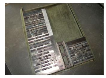
Zeile für Zeile entsteht in einem Winkelhaken - und das über Kopf und spiegelbildlich. Zwischenräume zwischen den einzelnen Worten werden ebenfalls einzeln mittels Spazien gebildet und die Zeilenabstände durch Regletten.
