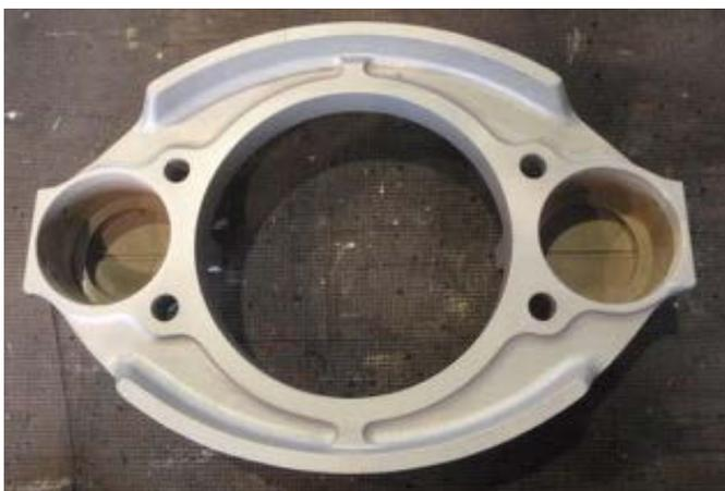
Bremsschild mit Aufnahme für die Hydraulikzylinder.
