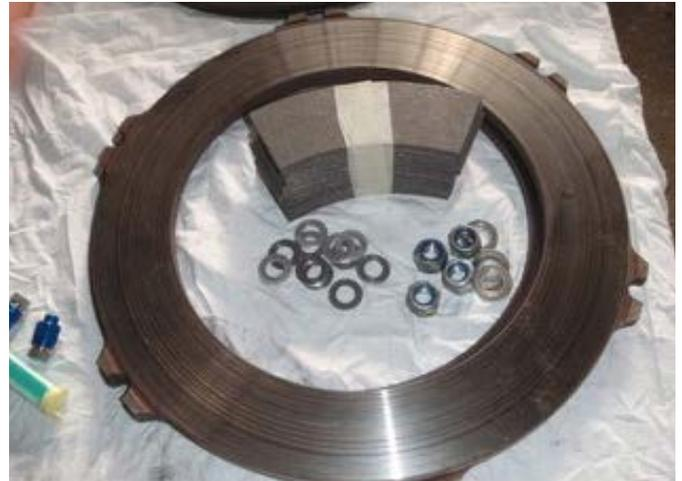
Zwei Bremsscheiben mit Bremsklötzen.
