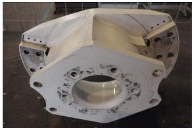
Ankerplatte mit Bremsklötzen (sitzt am Achsstummel).
