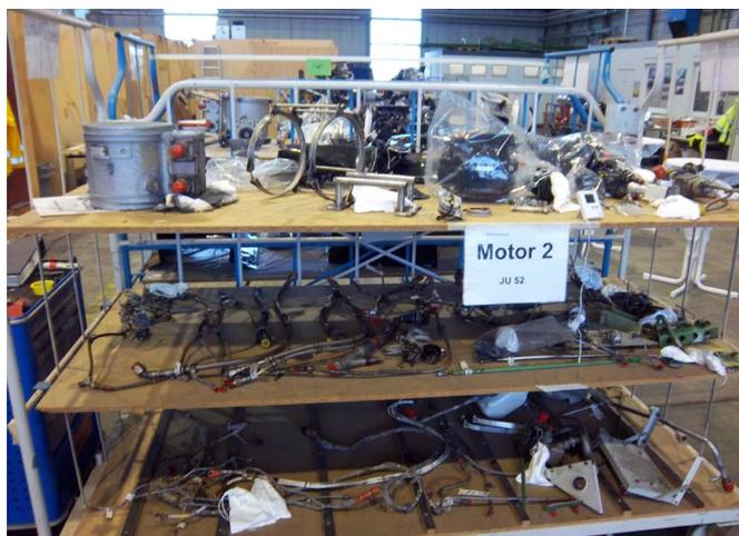
Diverse Komponenten eines Motors wurden ausgebaut und liegen für Kontrollen bereit. Nach bestandener Überprüfung werden die Teile als „Serviceable“ (= einbaufähig) mit einem grünen Anhänger gekennzeichnet. (ps)
