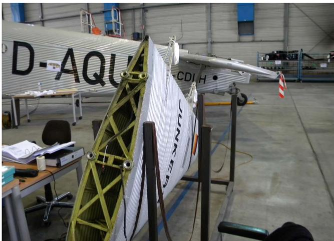
Das Seitenleitwerk musste ebenfalls für Kontrollen abgebaut werden. Außerdem ist dadurch der Zugang zum Rumpfbeck gegeben. (ps)
