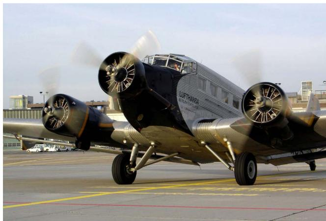
Die sogenannte „Base Maintenance“ ist überstanden. Als einer der abschließenden Tests am Boden findet ein Motorstandlauf statt. Erst danach geht es in die Luft zum Prüfflug, bei dem diejenigen Tests durchgeführt werden, die am Boden nicht zu machen sind weil das Flugzeug dazu „sein Element“ die Luft benötigt. (dlbs)
