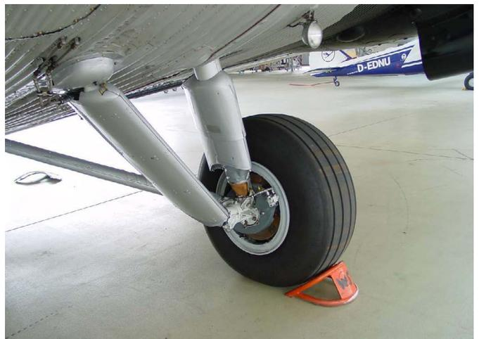
*Das Fahrwerk ist fertig und wieder eingebaut.*
