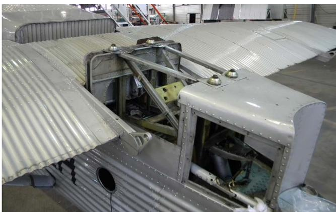
Hier ist der Platz für das Seitenleitwerk. Gut zu erkennen die vier Verschraubungen. Eine einfache und zweckmäßige Konstruktion, die einen schnellen Aus- und Wiedereinbau ermöglicht. Also schon zur damaligen Zeit ein wartungsfreundliches Konzept, das auch dazu diente, eine Ju 52 soweit schnell und praktisch auseinanderbauen zu können damit ein Transport auf einem Güterwaggon möglich ist. (ps)
