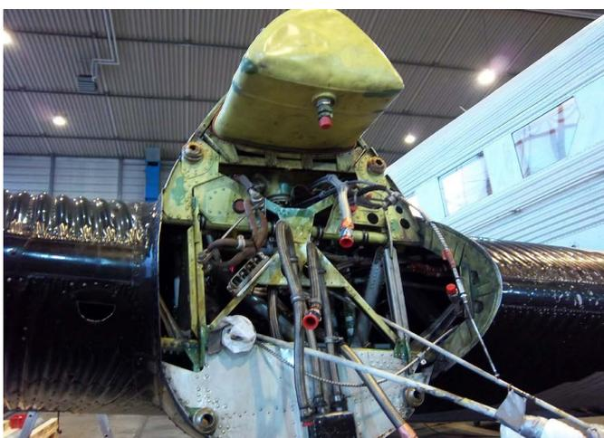
Auch der rechte Motor und das Motorgerüst sind abgebaut. Oben ist der grüne Öltank zu sehen. Die Anschlussöffnungen von Schläuchen und Rohren sind mit roten Kappen verschlossen damit keine Fremdkörper hineingelangen können. (ps)
