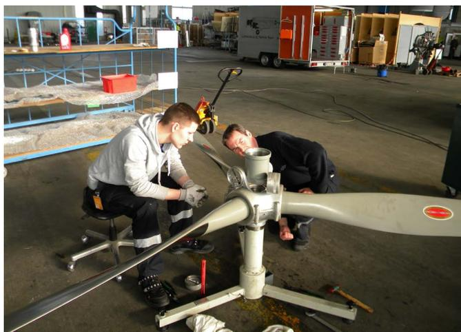
Der von einer Spezialfirma überholte Propeller wird zusammengebaut. Dem Techniker hilft dabei ein Auszubildender, der bei dieser für ihn seltenen Gelegenheit auch einmal an einem historischen Flugzeug unter Aufsicht arbeiten darf. (ps)
