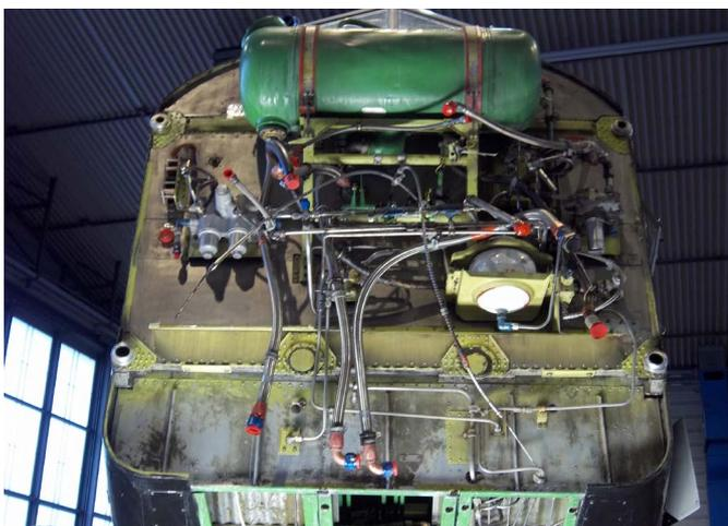
Der Mittelmotor ist inclusive des Motorgerüsts für Kontrollen und ggf. Reparaturen abgebaut. (ps)
