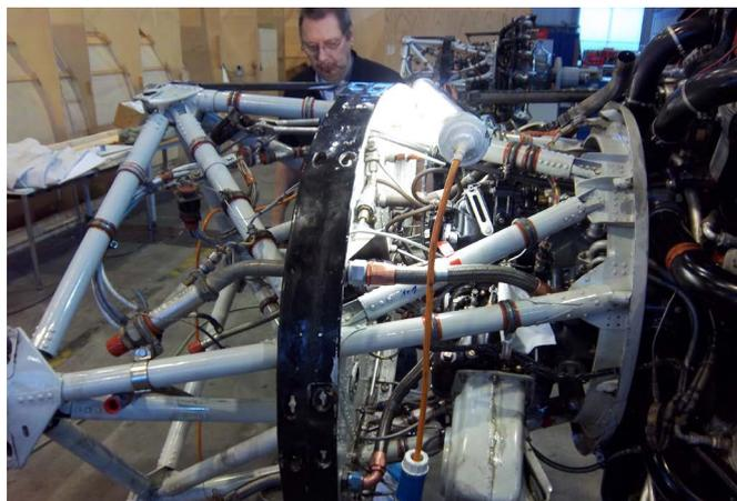
An einem der Motorgerüste wird gearbeitet. Die Kontrollen nach dem vorgegebenen Programm und die Reparaturen nach den entsprechenden Vorschriften. Danach geht es wieder an die Tragfläche: Die vielen Verbindungen zwischen Motor und Flugzeug sind wieder herzustellen und auf einwandfreie Funktion zu überprüfen. (ps)
