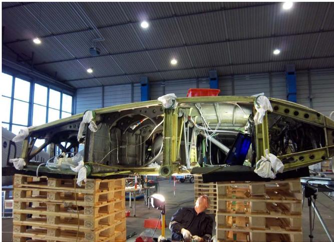
Hier liegt eine abgebaute Tragfläche. Die Kontrollen sind beendet und damit liegt der Reparaturumfang fest. Die Reparatur wird nach von Junkers vorgegebenen Anweisungen durchgeführt. Dieser Techniker muss dazu die damals üblichen Technologien beherrschen. (ps)
