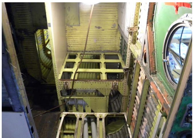
Die Kontrollen und Arbeiten sind hier schon beendet aber es braucht noch neuen Korrosionsschutzlack an einigen Stellen. Dann können die Staufächer und der Sitz für die Flugbegleiter/innen wieder installiert werden. (ps)
