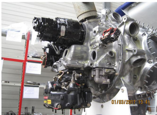
*An die Rückseite des Gehäuses sind, ebenfalls versuchsweise, Anbaugeräte wie Vergaser und Anlasser installiert. (ps)*
