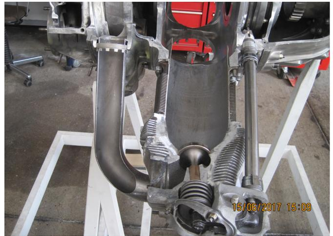
*Blick in einen aufgeschnittenen Zylinder und dem ebenfalls aufgeschnittenen Ansaugrohr.*
