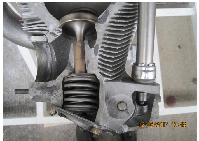
*Ein Ventil im Zylinderkopf.*
