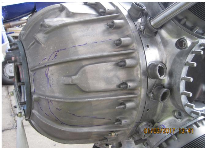
Am Gehäuse des Untersetzungsgetriebes ist der notwendige Ausschnitt angezeichnet. (ca)
