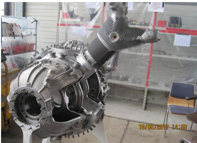
*Motor- und Getriebegehäuse mit einem Zylinder.*
